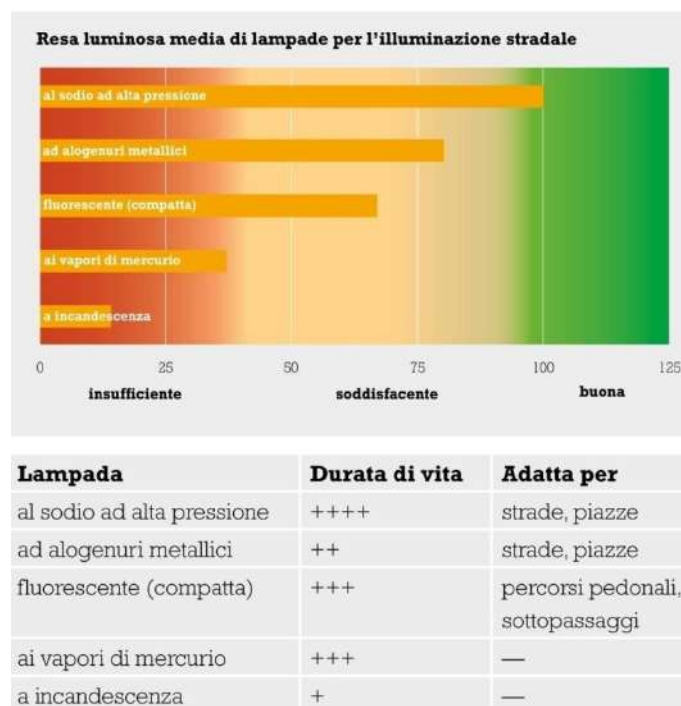
Figura 6. Resa luminosa e caratteristiche delle lampade installate nelle strade italiane.
