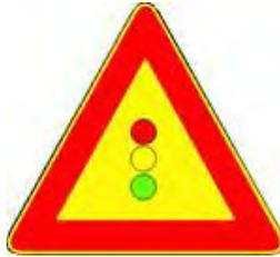
Fuori dei centri abitati l'impianto semaforico deve essere preceduto dal segnale di pericolo temporaneo SEMAFORO (fig. II.404) con una luce gialla lampeggiante inserita al posto del disco giallo del simbolo
