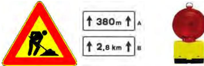
In prossimità di cantieri fissi o mobili, anche se di manutenzione, deve essere installato il segnale LAVORI (fig. II.383 – figura a lato) corredato da pannello integrativo indicante l'estesa del cantiere quando il tratto di strada interessato sia più lungo di 100 m.
